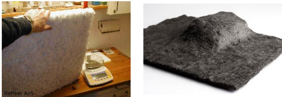
Figure 103 : Illustration de mats issus de fibres de verre (crédit : ReFiber ApS à gauche) et fibres de carbone recyclées (crédit : Gen2Carbon à droite).
